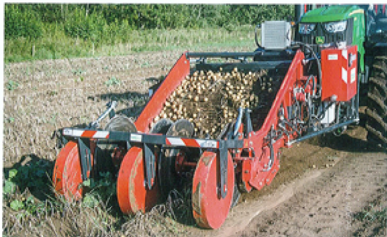
Unikatowe, dwurzędowe kopaczki Tolmac, montowane na przednim TUZ ciągnika, przeznaczone są do równoczesnej pracy z kombajnem zoczekowanym, również dwurzędowym.
